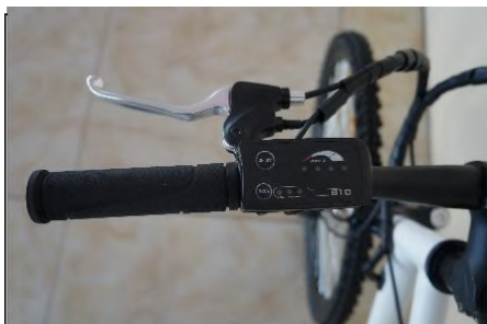
Figura 9- Led visualizzazione carica batteria e accensione.
