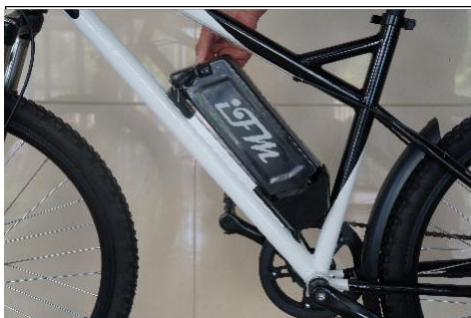
Figura 13- Estrazione della batteria dalla propria sede.
