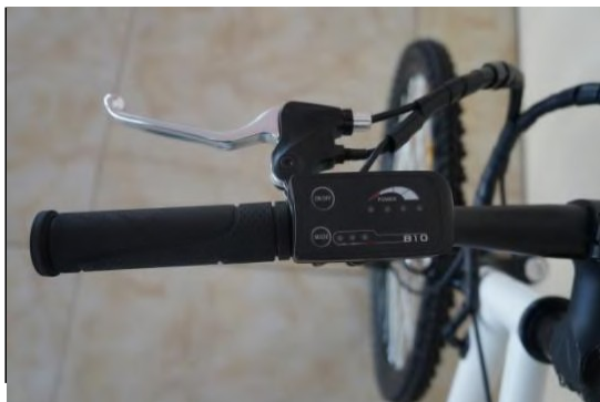
Figura 14 - Visualizzatore del livello di carica della batteria.
