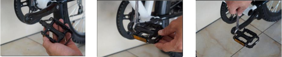
Figura 3 - Montaggio dei pedali.
