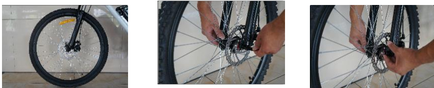
Figura 2 - Montaggio della ruota anteriore.
